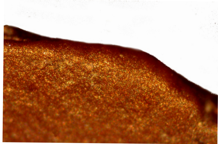
Скругление рабочей кромки. Вид со спинки. Увеличение 50X
